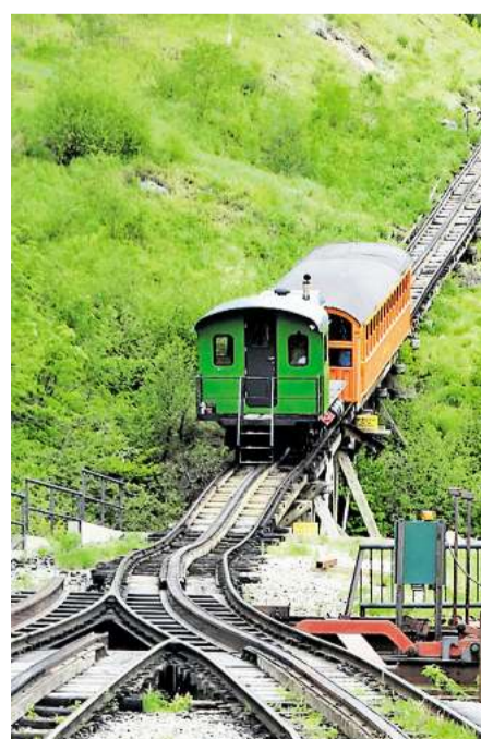
Die Zahnradbahn von 1869 fährt auf den Gipfel des 1917 Meter hohen Mount Washington. Die Dampflok benötigt pro Fahrt etwa eine Tonne Kohle und fast 4000 Liter Wasser.
